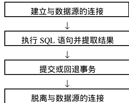
图 (3) 使用 ODBC 实现局部代理的程序结构
